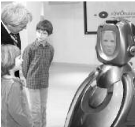
A magyar fejlesztésű, 100 kilogramm súlyú hosztesszrobot, amely képes a látogatókkal kommunikálni, speciális érzékelői segítségével köztük gond nélkül mozogni
