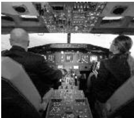
A Boeing 737 szimulátora az igazi pilótafülkék pontos másával, hanghatásaival, a reptereknek és környéküknek képi megjelenítésével a repülőgépezetés élményét adja a „pilótáknak”
